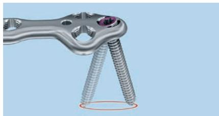
Die Schraubenlöcher erlauben die Schraubeninsertion mit variablen, in alle Richtungen um bis zu 15° von der zentralen Lochachse abweichenden Winkeln.
